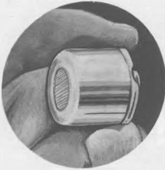
Fig. 237bis – Le microphone ultrasonique 1404 équipant l'émetteur et le récepteur
