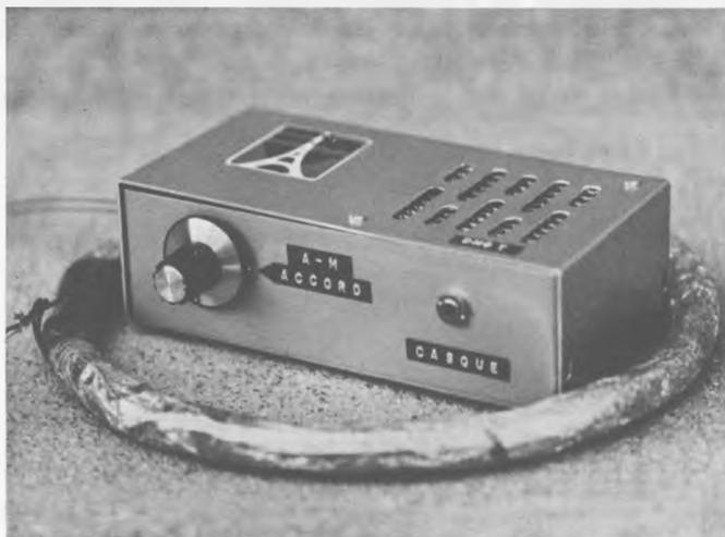
Fig. 175 – L'appareil D.M.6.T. et son cadre de recherche
